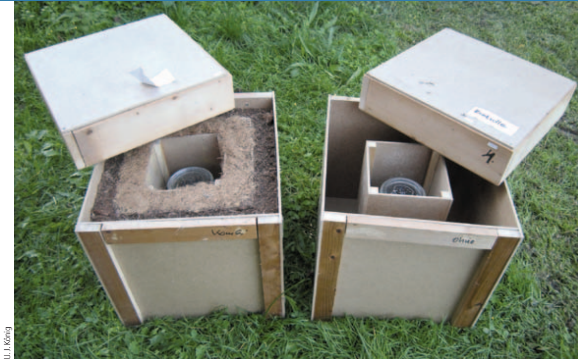
Abb. 3: Lagergefäße für den Versuch. Links: Füllung mit Torf/Kokosfaser, rechts die leere Kontrolle
