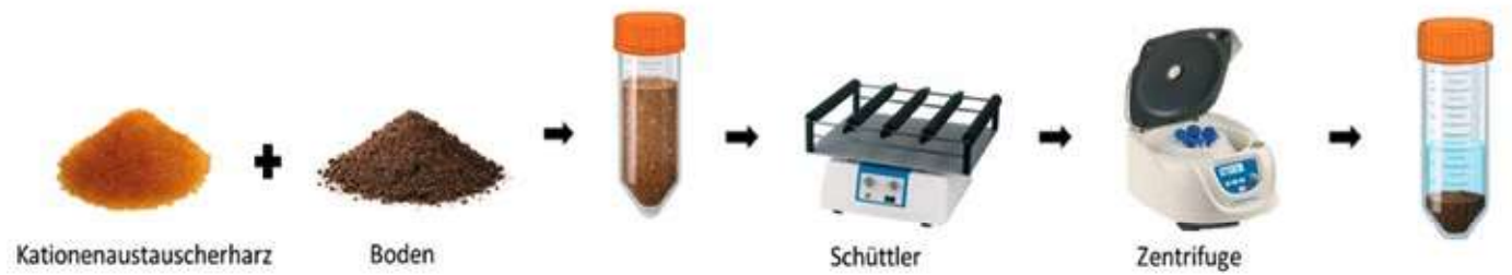
ABB. 2: VERFAHREN ZUR EPS-EXTRAKTION UNTER VERWENDUNG VON KATIONENAUSTAUSCHERHARZ
